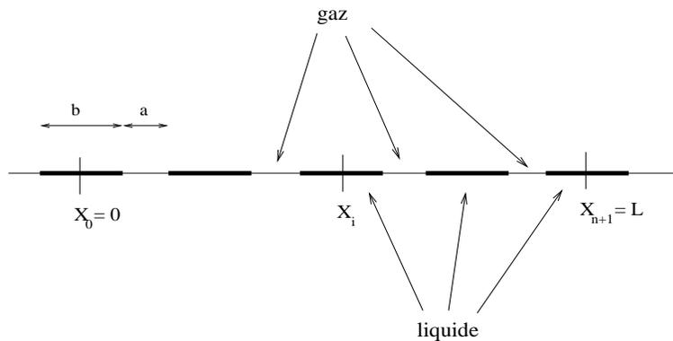
On note  $\rho$  la masse linéique du liquide, de telle sorte que la masse d'un "segment"  $S_i$  centré en  $x_i$  est  $\rho b$ . Le gaz piégé entre deux segments successifs est supposé obéir à la loi des gaz parfaits à température constante, c'est-à-dire
